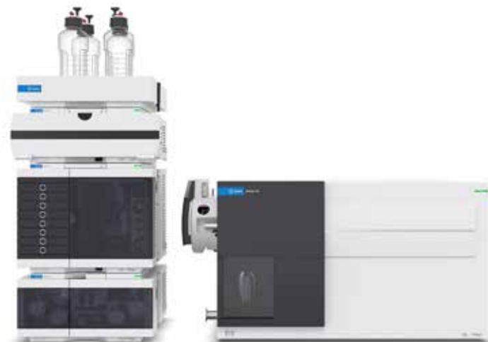
Figure 6. Système chromatographique LC-ESI-MSMS utilisé pour le dosage.
